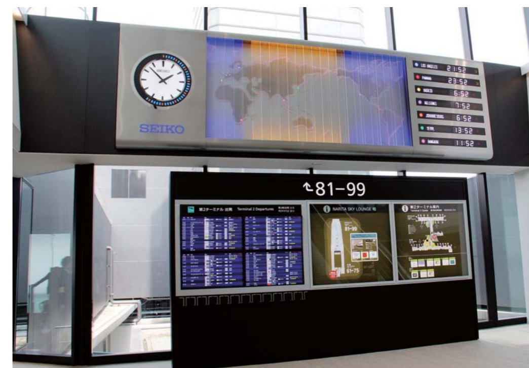
成田国際空港第2ターミナル 世界時計 / 2015年4月設置 世界35都市から7都市ずつをスクロール表示。中央の世界地図は毎正時と30分に季節感を表すカラーでデモンストレーションを行います。
