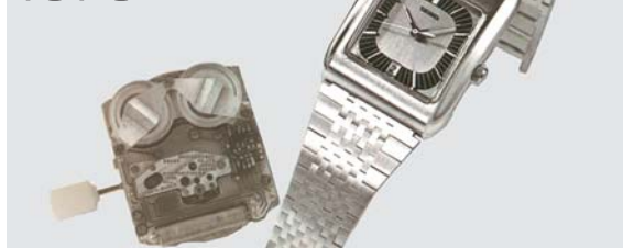
世界初 CMOSICを搭載した腕時計「クオーツ アストロン365QC」
