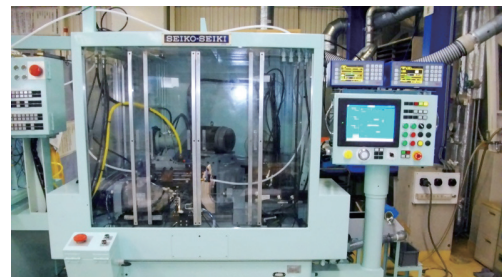
オーバーホールおよびレトロフィット後
