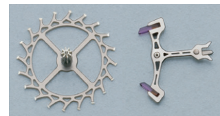
MEMSを使うことで軽量化と耐久性向上に成功した「がんぎ車(左)」と「アンクル(右)」
