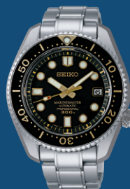
ベゼル上の文字をレーザーの陽極酸化処理で金色仕上げ。剥脱や色褪せすることがない。
