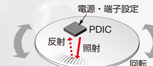
光エンコーダの仕組み
