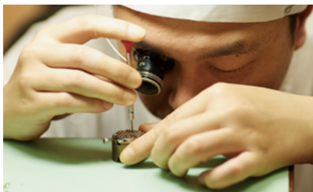
「現代の名工」によるムーブメント組立作業
